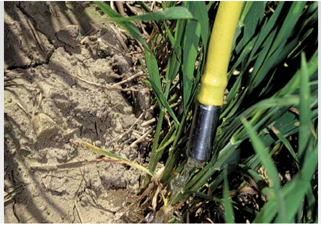
Masselotte en acier spécial sur le localisateur
